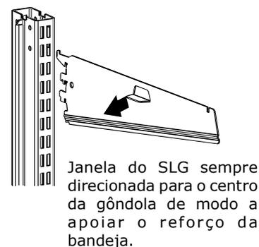
**6** Encaixar as bandejas sobre o par de SLG, sempre apoiando o reforço das bandejas sobre a janela do SLG.
