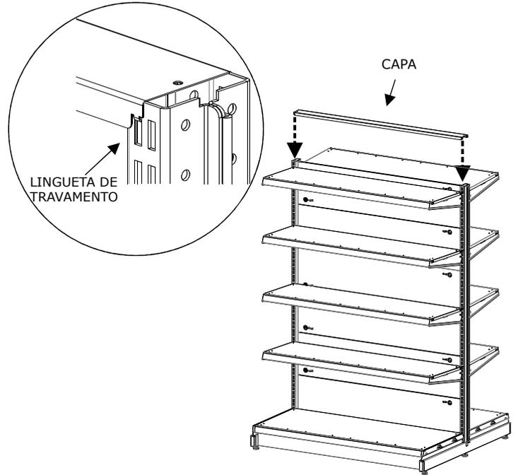
**8** As Gôndolas Gold são fornecidas em módulos, sendo assim para cada fileira de Gôndola é necessário um módulo inicial e o restante da montagem em módulos de continuação, utilizando sempre a última coluna do módulo anterior para dar sequência na montagem.
