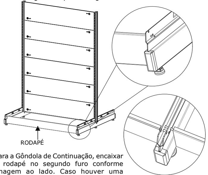
Para a Gôndola de Continuação, encaixar o rodapé no segundo furo conforme imagem ao lado. Caso houver uma terceira gôndola, encaixar no primeiro furo e assim subsequente às demais.
