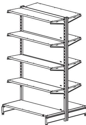
Para montagem da Gôndola de Ponta Face basta repetir os passos de 1 a 5 mostrados anteriormente e obedecer o detalhe do travamento superior mostrado em imagem abaixo.
